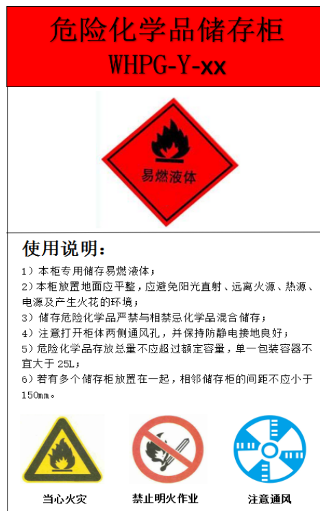
图 A.3 易燃液体储存柜标签
